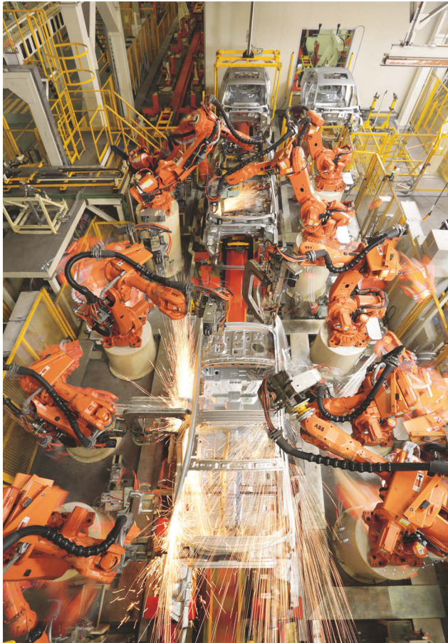
Industrieroboter schweißen eine Autokarosserie zusammen.
