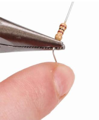
*Halte das Bauteil fest und biege den Anschlussdraht nach unten. Mit der anderen Seite des Bauteils machst du dann noch einmal das Gleiche.*
