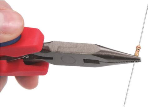
*Greife zuerst das Bauteil am Anschlussdraht, den du verbiegen willst.*
