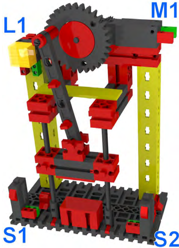
Manuelle Stanzmaschine bei der das Werkstück von Hand eingelegt wird
